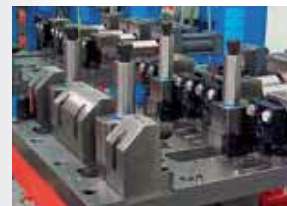
Die Berechnung von Spannvorrichtungen zur Bearbeitung von Profilen, in diesem Fall von acht Metern Länge, gehört zu den Kompetenzen der Mechatronik-Experten.
