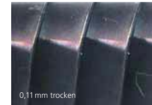
Das 3-D-Digitalmikroskop liefert den Beweis: Mit Trockenbearbeitung ist der Verschleiß an Werkzeugen zur Metallverarbeitung deutlich geringer.
